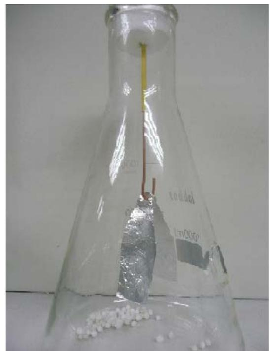
Figura 2. Electroscopio casero fabricado para el experimento
