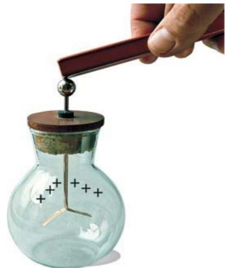
Figura 1. Ejemplo de un electroscopio
