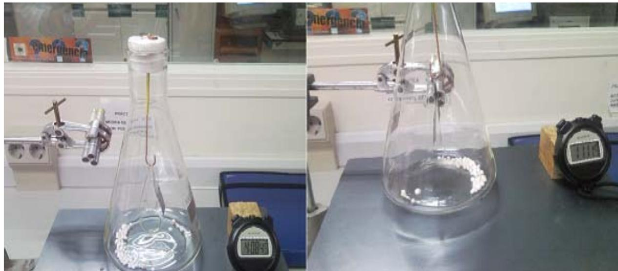
Figura 4. Electroscopio sin presencia de la fuente de  $^{241}\text{Am}$  (izquierda) y con la fuente de  $^{241}\text{Am}$  (derecha)
