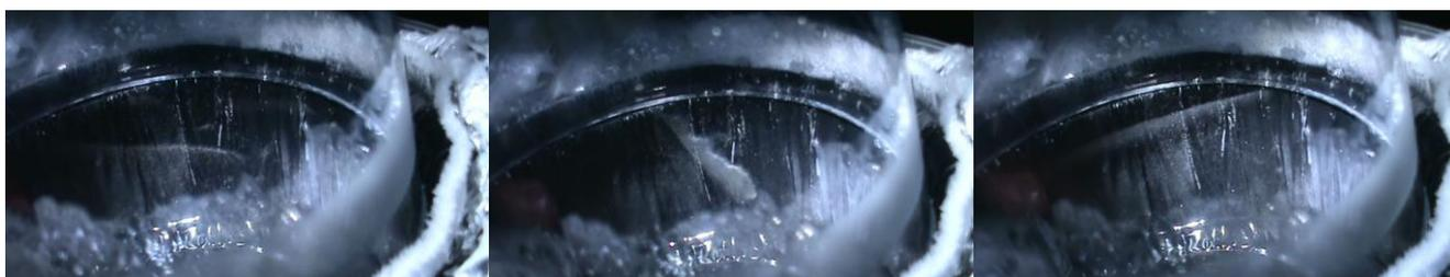
Fig. 6. Imágenes de trazas observadas con la cámara de niebla SLC cuyo coste real no supera los cinco euros.
