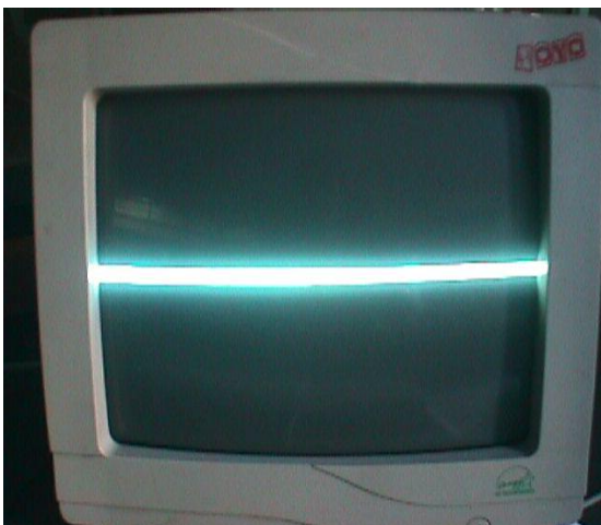
Foto 7. Barrido vertical desconectado
