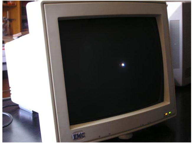
Foto 2. Haz de electrones en el centro de un monitor
