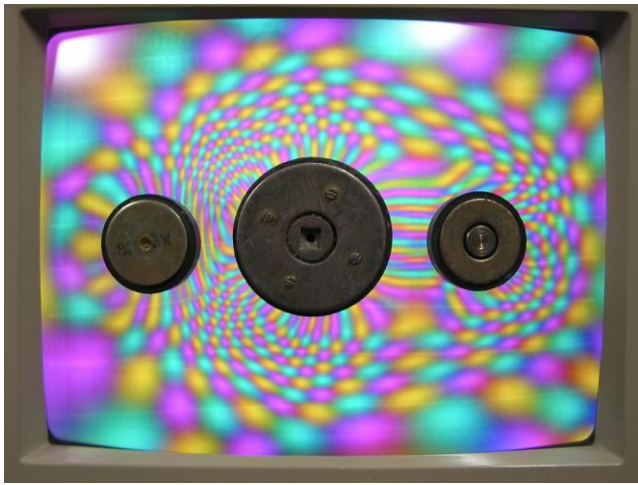
Foto 1. Líneas del campo magnético en atracción y repulsión
