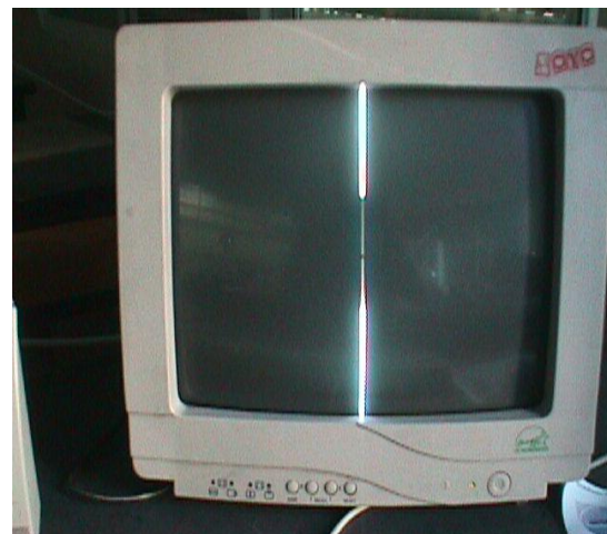
Foto 8. Barrido horizontal desconectado
