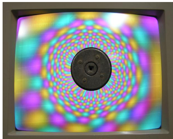
Foto 12. Campo magnético del imán de un altavoz
