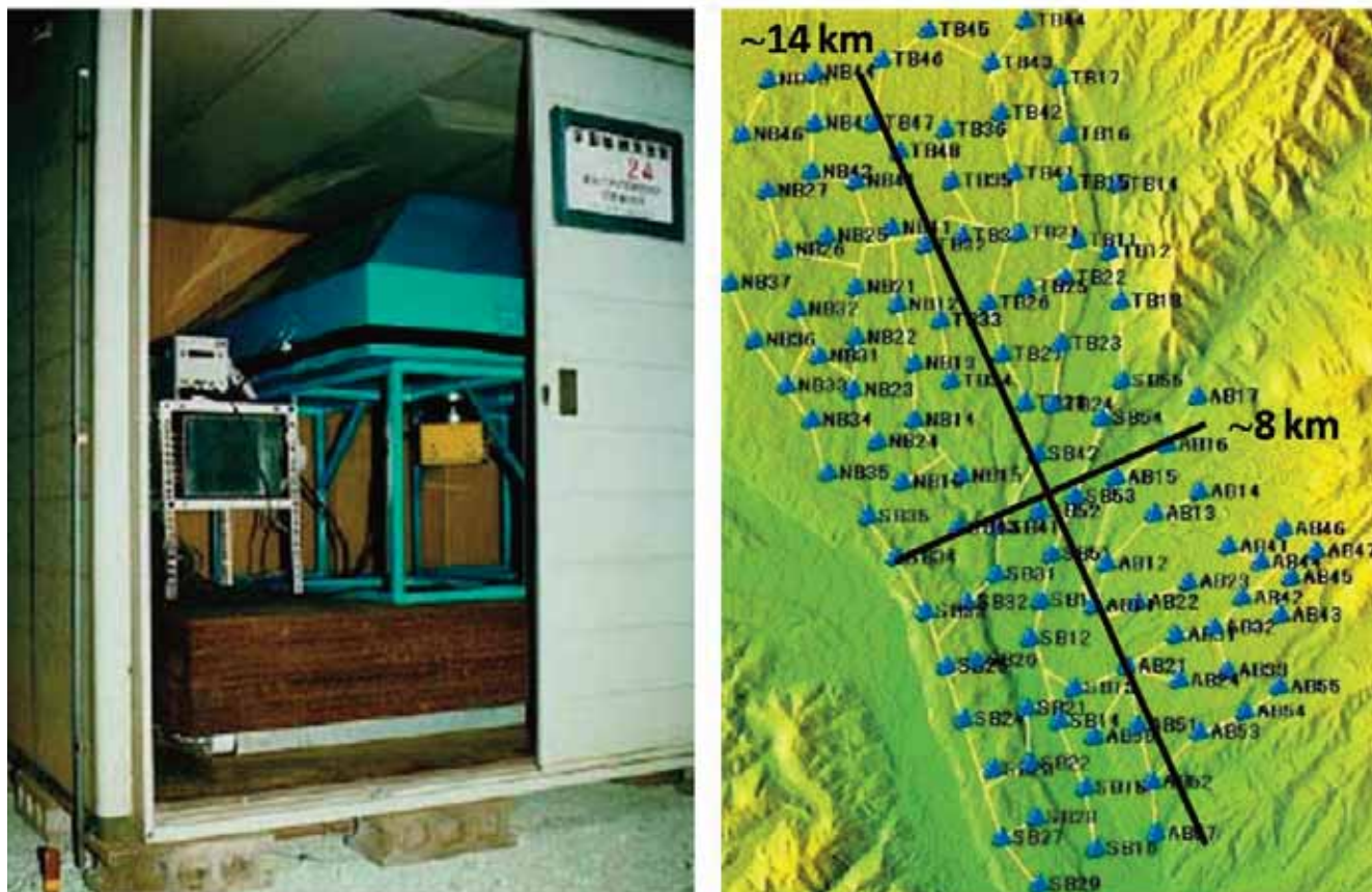
Figura 8. Akeno Giant Air Shower Array (AGASA). Distribución en el suelo de los detectores de la cascada (derecha) y uno de los detectores individuales (izquierda).
