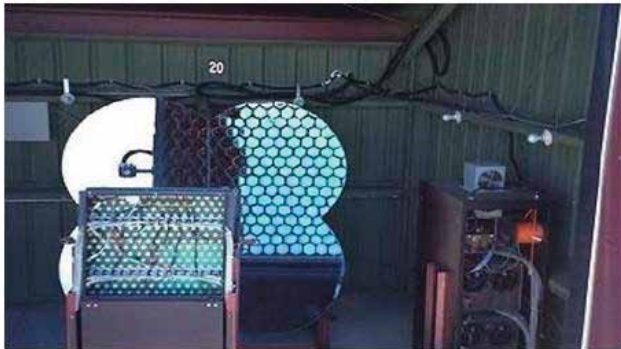
Figura 9. Algunos de los espejos del detector de fluorescencia Fly's Eye (arriba). Uno de los telescopios del proyecto HiRes (abajo).
