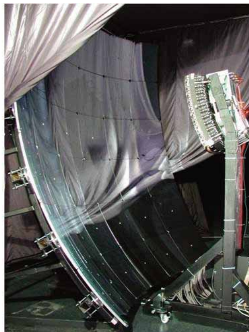
Figura 12. Detector de fluorescencia del Observatorio Pierre Auger. Cada una de las estaciones (izquierda) consta de cuatro telescopios, uno de los cuales se muestra en la figura (derecha).
