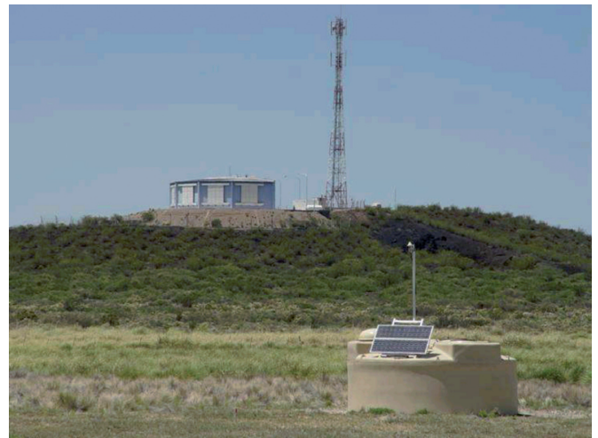
Figura 3. Uno de los 1600 tanques de agua que constituyen el detector de superficie del Observatorio Pierre Auger. Se puede ver al fondo uno de los edificios de fluorescencia, con las cubiertas 3 de los 6 telescopios de fluorescencia cerradas para proteger los fotomultiplicadores de la luz del día.
