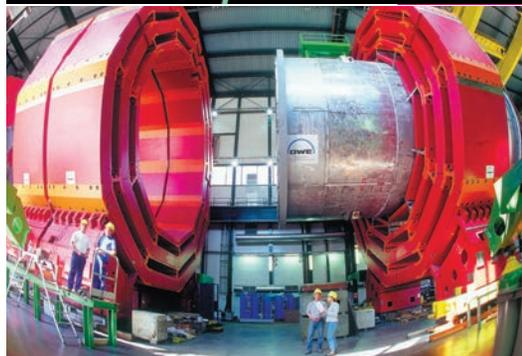
Las diferentes capas del detector miden diferentes propiedades de las partículas producidas por las colisiones. Los detectores de trazas revelan la trayectoria de las partículas resultantes de la colisión. Otras capas, los calorímetros, miden la energía de las partículas. En los detectores, un imán curva las trayectorias de las partículas cargadas eléctricamente y ayuda a identificarlas.
