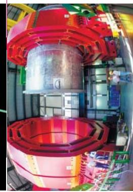
Las diferentes capas del detector miden diferentes propiedades de las partículas producidas por las colisiones. Los detectores de trazas revelan la trayectoria de las partículas resultantes de la colisión. Otras capas, los calorímetros, miden la energía de las partículas. En los detectores, un imán curva las trayectorias de las partículas cargadas eléctricamente y ayuda a identificarlas.
