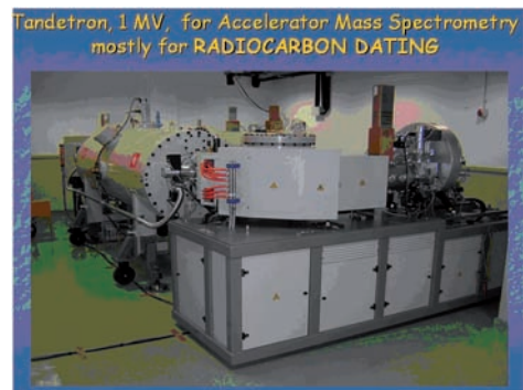
Figura 7. Instalación de Espectrometría de Masas con Acelerador (AMS) del CNA. Consta de una fuente de iones con intercambiador con capacidad para 200 muestras y de un acelerador tandem de tipo Cockroft-Walton de 1 MV.
