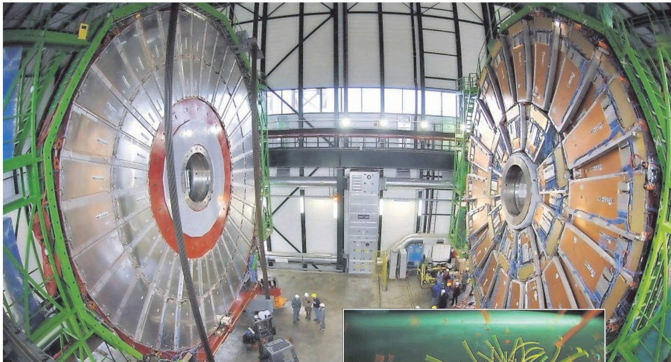
El Solenoide Compacto de Muones, donde se detectan partículas, y sus trazas de choques
