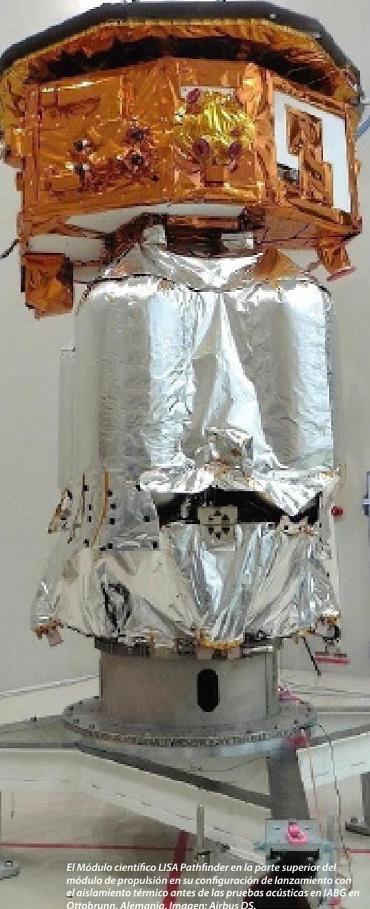
El Módulo científico LISA Pathfinder en la parte superior del módulo de propulsión en su configuración de lanzamiento con el aislamiento térmico antes de las pruebas acústicas en IABG en Ottobrunn, Alemania. Imagen: Airbus DS.
