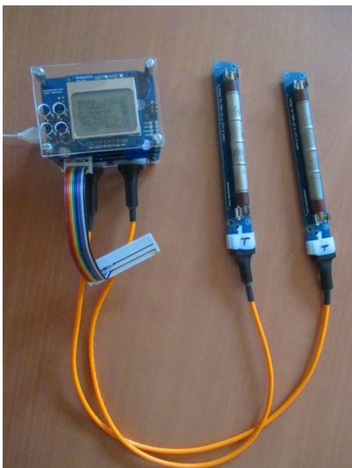
Fig. 1: Los dos tubos Geiger (derecha) conectados a la electrónica del detector
